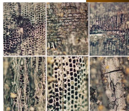
**Figura 60.** Imagens com microscópio óptico de luz reflectida de diversas superfícies de fractura de diferentes fragmentos de carvão.
