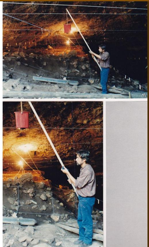
**Figura 36. Sistema de aquisição de imagens vídeo na vertical.** A câmara de vídeo é colocada num suporte oscilante que permite manter-se vertical sobre o objecto a filmar. A captura de imagens é auxiliada por um pequeno monitor portátil; A câmara de vídeo é accionada por controlo remoto.
