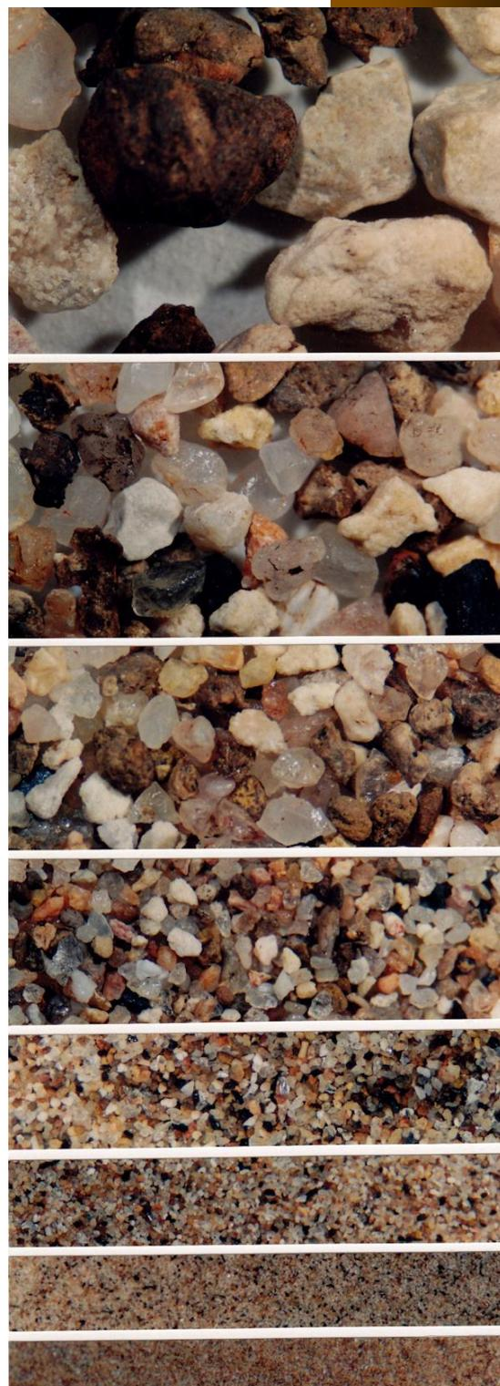
**Figura 68.** Série de fracções granulométricas de uma amostra sedimentar, observadas sob lupa binocular.
